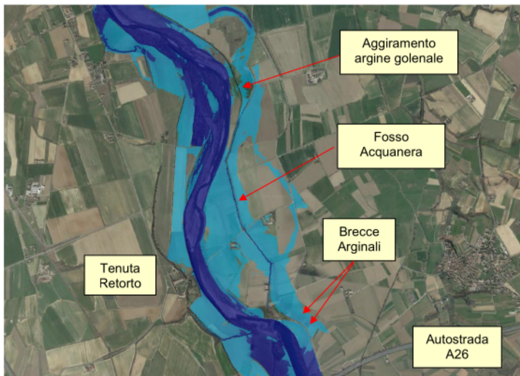
FIGURA 5-7 DETTAGLIO DELLA DINAMICA DI ALLAGAMENTO CONSEGUENTE ALLA FORMAZIONE DELLE BRECE SULL'ARGINE STRATEGICO A VALLE DELL'AUTOSTRADA A26 (EVIDENZIATE IN ROSSO)
